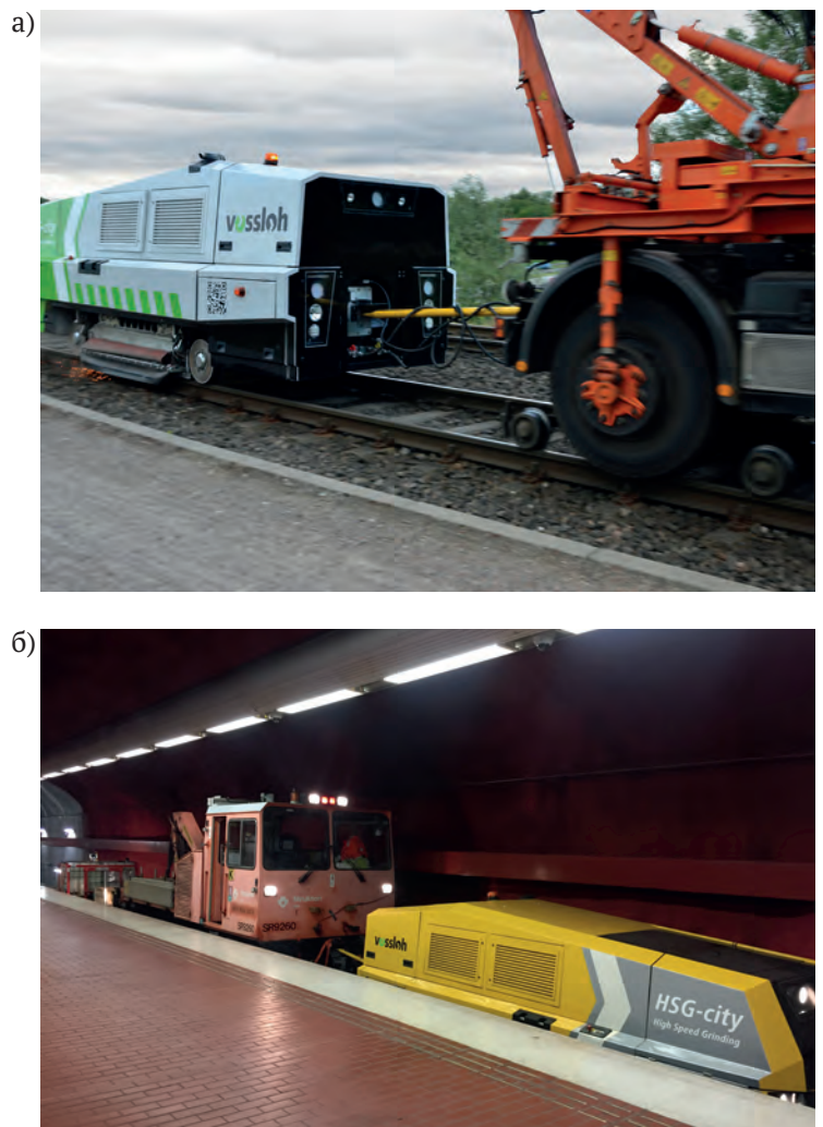
Рис. 3. Варианты использования тягового подвижного состава с HSG-city: а) машина, ведомая автомобилем на комбинированном ходу Unimog (на одном из рабочих выездов в Ростке, Германия); б) машину тянет локомотив в Стокгольмском метрополитене
